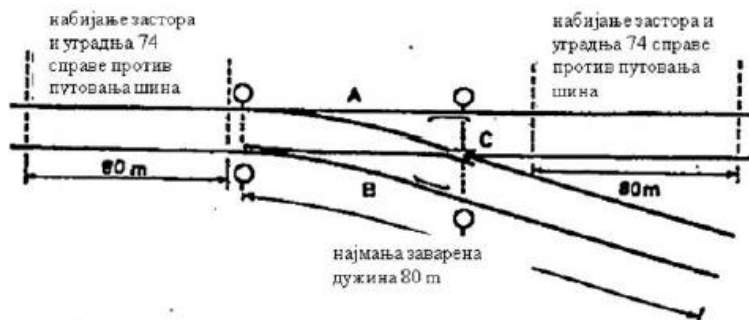
Слика 42: Уградња справа против путовања шина
