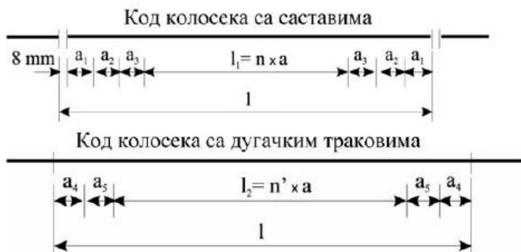
Слика 5: Распоред прагова на дужини једног шинског поља
