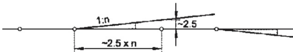
Слика 31: Нормално растојање скретница
